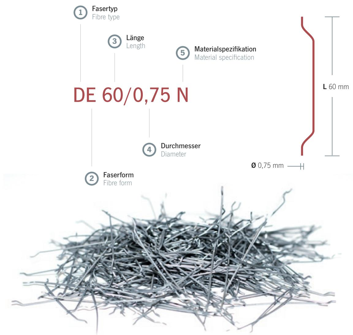
Die Produktbezeichnungen ergeben sich aus den verschiedenen Parameter-Angaben der Faser. Dieses Beispiel zeigt die Produktbezeichnung einer KrampeHarex®-Drahtfaser mit Endhaken, 60 mm Gesamtlänge und 0,75 mm Durchmesser, Normalfest.
