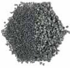
Stahlguss-Strahlmittel, hochgekohlt Steel shot/steel grit, high-carbon (HC)
